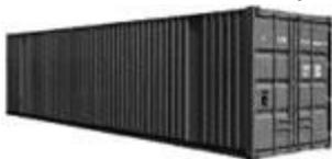
Контейнер общего назначения.(ISO 1496/1): Контейнер полностью закрытый и пылеводонепроницаемый, имеющий жесткую крышу, жесткие боковые стенки, жесткие торцевые стенки, имеющий хотя бы в одной торцевой стенке двери и предназначенный для перевозки и хранения широкой номенклатуры грузов.
