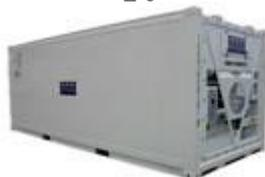
Рефрижераторный контейнер с машинным охлаждением: Изотермический контейнер, имеющий холодильную установку (механический компрессор, абсорбционную установку и т.д.).
